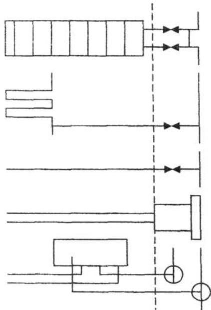
**Отопление** – до первого вентиля (вкл.) радиатора отопления в помещении
